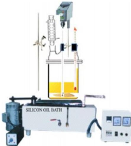
**Figure 2.** Lignocellulosic liquefaction apparatus.
